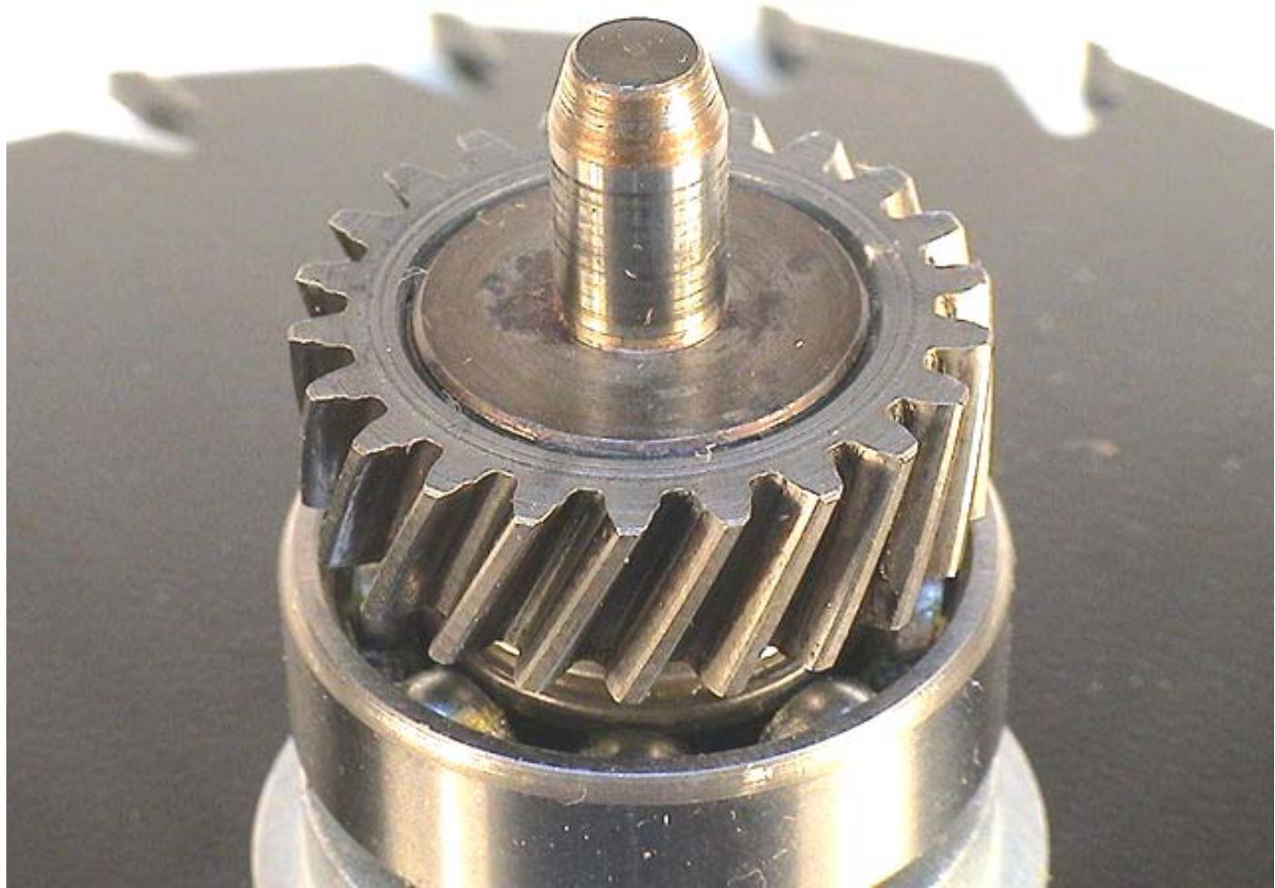
Detail ozubeného kola z ruční kotoučové pily
